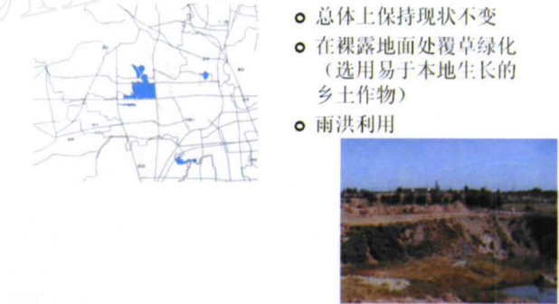
图 8 修复为蓄滞洪区的砂石坑
